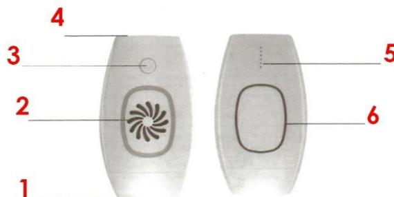
1. Janela de flash / saída de luz pulsada, 2. Entrada de ar de arrefecimento, 3. Botão de alimentação/intensidade, 4. Saída de ar de arrefecimento, 5. Indicador luminoso de intensidade/pronto, 6. Botão de flash
